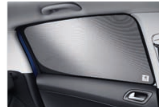
Stores pare-soleil latéraux Ces stores permettent une occultation totale des vitres latérales arrière.
